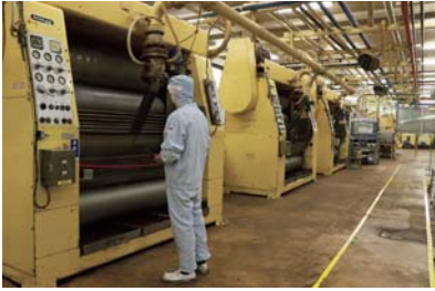
微粒化をする機械で原材料をさらさらしています
